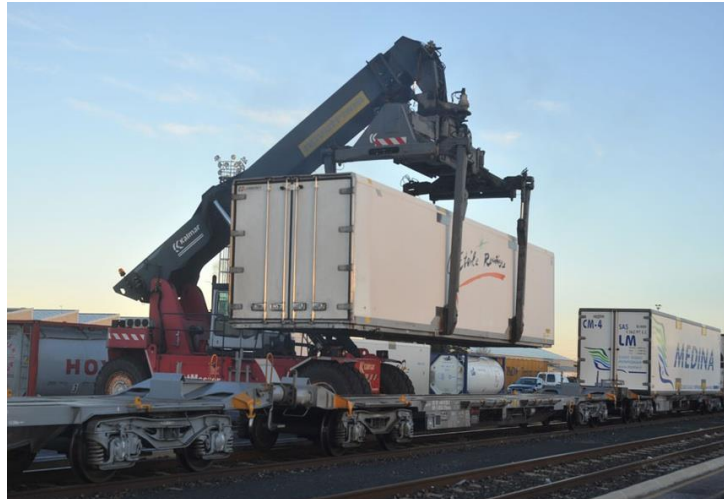
Opération de transbordement rail-route. Source : (Actu Transport Logistique, 2018a)
