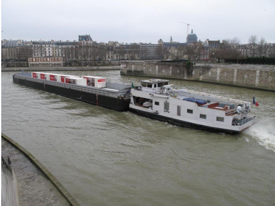
Pousseur et barge d'approvisionnement de certains magasins Franprix à Paris. Source : Wikipédia.
