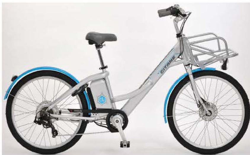
L'Alter Bike de Gitane, alimenté par une pile à hydrogène, sera disponible pour les collectivités dès 2014. © Cycleurope
