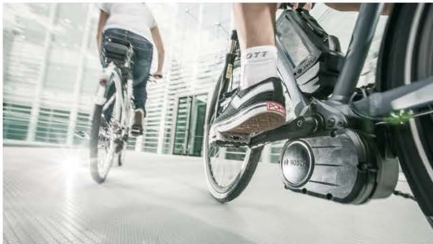
Le moteur Bosch, fixé au centre du vélo, fait autorité mais reste la solution la plus coûteuse. Financièrement plus accessibles, les motorisations placées à l'avant ou à l'arrière apportent un autre équilibre au vélo. © Scott sports
