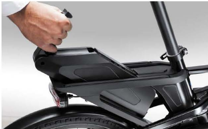
Le temps de charge d'environ quatre heures de la batterie suppose une facilité d'accès. © Matra
