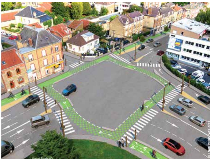
Un des quatre carrefours à la hollandaise qui vont être aménagés à l'entrée de la ville dans ce plan d'apaisement généralisé de Charleville-Mézières.
